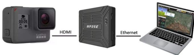
MF05E 可以将输入的 HDMI 高清视频进行 H.265/H.264 压缩编码，并转换为标准的 RTSP 视频流。GoPro 作为视频源，以 PC 为例，如上图所示连接，介绍如何获取 MF05E 的视频流。
