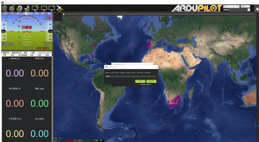
进入 Mission Planner 地面站，右上角选择 UDP，点击连接后会弹出 Listen port 窗口，输入栏填入 14550（如果 M51 的地面端串口 1 的 UDP 已更改，请填入更改后的端口号，详见网页配置功能说明），点击 OK 即可获取到数据。
