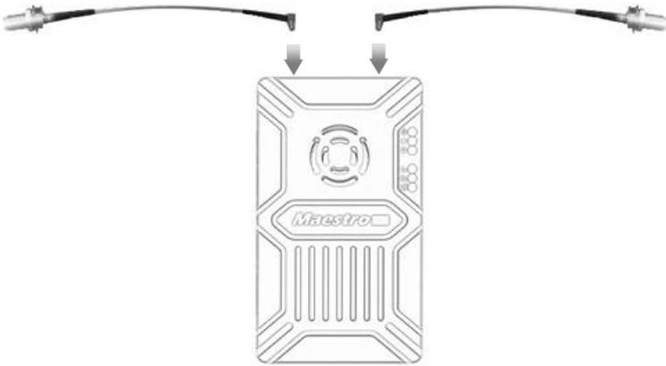
1.2 将设备和射频馈线固定在机架上，安装好天线，注意天线的 SMA 接口要拧紧，使天线竖直向下的通信效果最佳，同时天线附近 20cm 范围内没有金属物体且没有遮挡。
