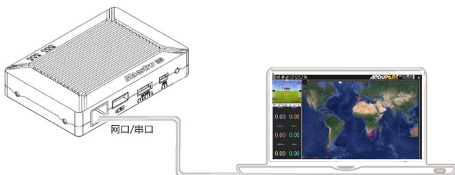
地面端与上位机的连接示意图
